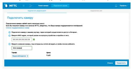
В поле 2 МАС-адрес камеры введите 12 символов МАС-адреса (Мас-адрес напечатан на коробке камеры или на задней стороне самой камеры).
