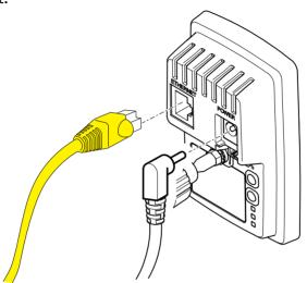
2 Подключите блок электропитания камеры к электросети и дождитесь её полной загрузки.
