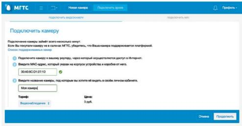
В поле 2 «МАС-адрес намеры» введите 12 символов МАС-адреса (Мас-адрес напечатан на коробке от камеры или на задней стороне самой камеры).
